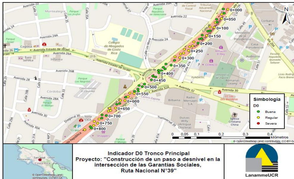
Figura 26. Mapa condición estructural según el indicador d_0 en los carriles del tronco principal. Fuente: LanammeUCR, 2020
