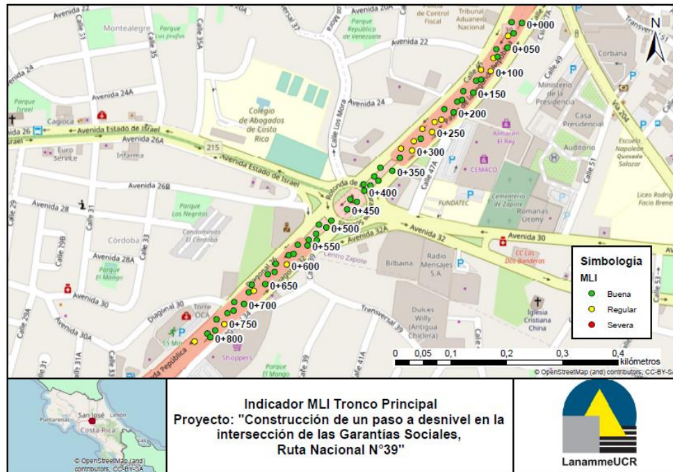
Figura 24. Mapa condición estructural según el indicador MLI en los carriles del tronco principal. Fuente: LanammeUCR, 2020.
