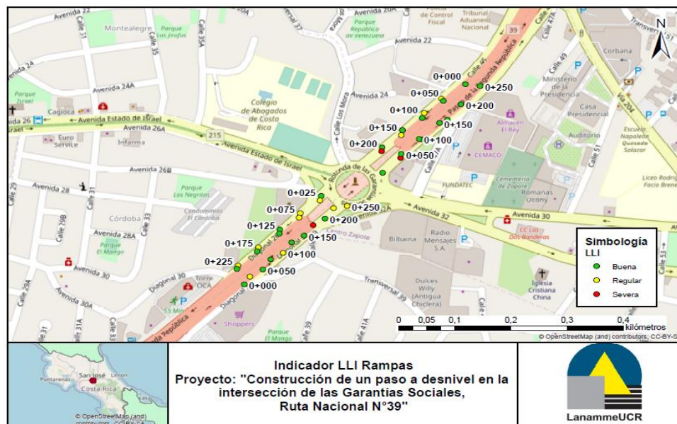
Figura 38. Mapa condición estructural según el indicador LLI en los carriles de las rampas evaluadas. Fuente: LanammeUCR,2020.
