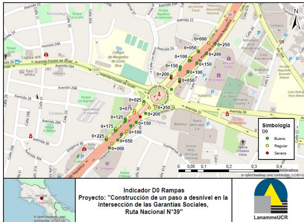
Figura 39. Mapa condición estructural según el indicador d_0 en los carriles de las rampas evaluadas. Fuente: LanammeUCR, 2020
