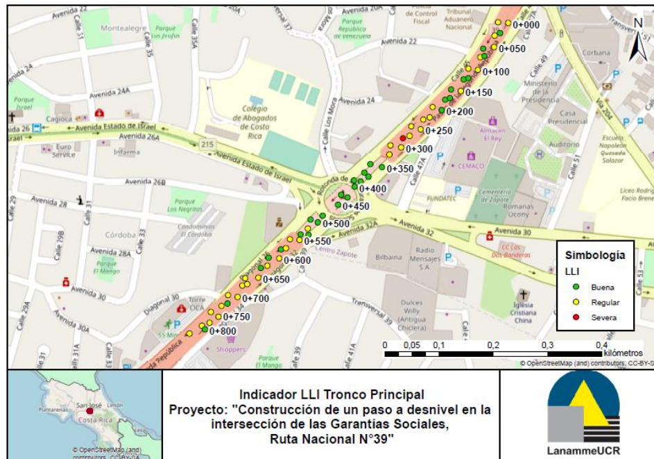
Figura 25. Mapa condición estructural según el indicador LLI en los carriles del tronco principal. Fuente: LanammeUCR, 2020.
