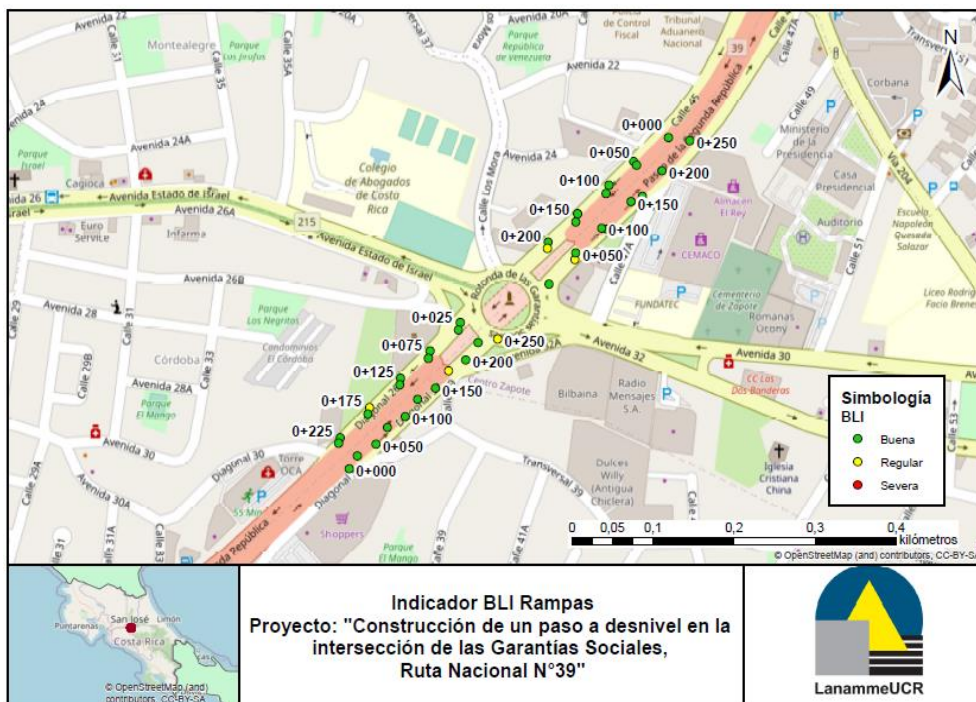
Figura 36. Mapa condici3n estructural seg3n el indicador BLI en los carriles de las rampas evaluadas Fuente: LanammeUCR,2020.
