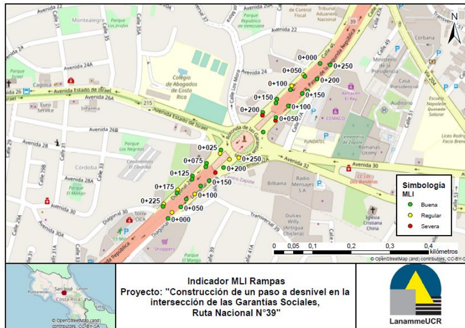
Figura 37. Mapa condición estructural según el indicador MLI en los carriles de las rampas evaluadas. Fuente: LanammeUCR,2020.
