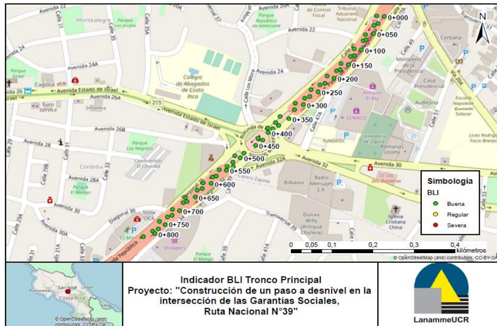
Figura 23. Mapa condición estructural según el indicador BLI en los carriles del tronco principal. Fuente: LanammeUCR,2020.
